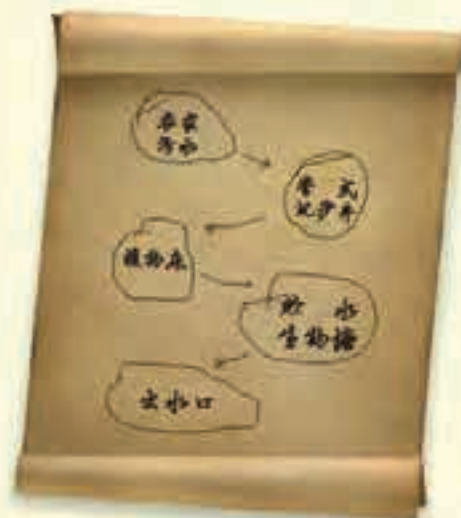
家园污水人工湿地的结构图示
